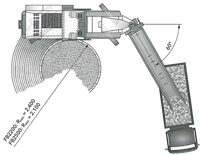
Fräskreis bei Frästiefe 150 mm, Abmessungen in mm
